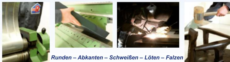
Runden – Abkanten – Schweißen – Löten – Falzen
